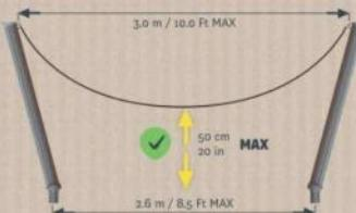
**FR** Installer la ou les bases d'ancrage afin que la distance entre les deux points de fixation du hamac n'excède pas 3m (entre 2,6m maximum entre les bases d'ancrage) et que sa hauteur par rapport au sol soit située entre 40 et 50cm à vide (voir schéma ci-dessus)
